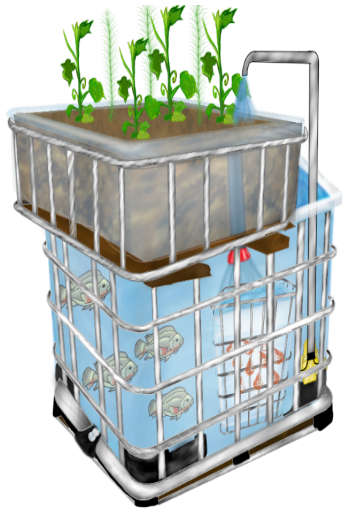
Figura 3. Diseño del sistema acuapónico para evaluar el crecimiento de tilapia y acociles.
