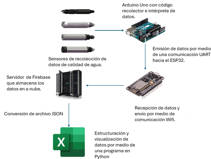
Figura 4. Diagrama de arquitectura del sistema.
