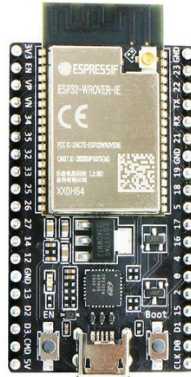
Figura 12. Módulo de placa de desarrollo ESP32.
